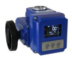
Atuador Elétrico Bongas inteligente com display LCD de operação local/remoto, com botões não intrusivo de comando, sistema de controle ON/OFF ou proporcional (4-20mA), retorno de sinal por micro switch ou 4-20mA, base ISO 5211, corpo em alumínio, indicador de posição visual local, Grau de Proteção IP 67.
